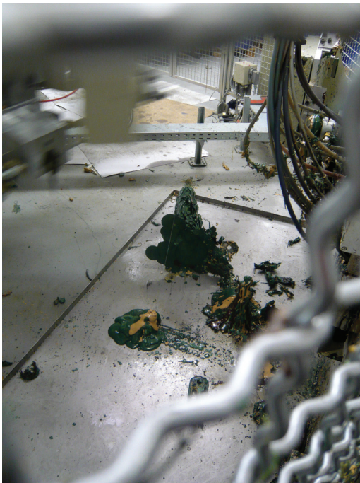
Growth of a drooling beneath the carousel. Überschüssiges Material, das sich unter dem Karussell ansammelt.
