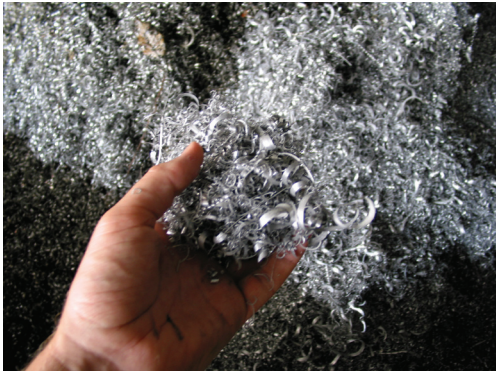
Steel and aluminium swarf from turning. Stahl- und Aluminiumspäne entstanden beim Drehen
