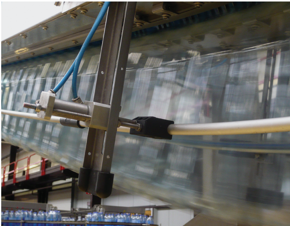
Empty PET bottles being flung off to the filling section by means of a compressed air-driven, suspended guideway. Leere PET-Flaschen werden mittels Druckluft über eine Führungsbahn zur Abfüllstation befördert.
