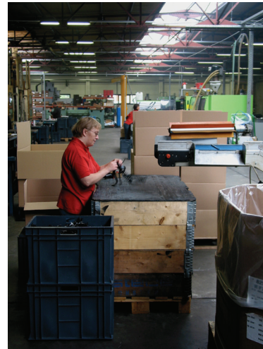
a worker removes injection molded pieces from their sprues. Ein Arbeiter entfernt die Spritzgussformen von den Angussresten.
