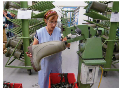
A worker inspects the boots while trimming the flashes. Ein Arbeiter prüft die Stiefel während des Zuschneidens.
