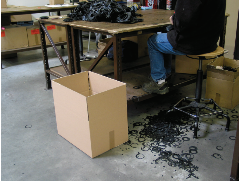
Flashes are manually removed by a worker with a pair of scissors Gussgrate werden von einem Arbeiter mit einer Schere manuell entfernt.
