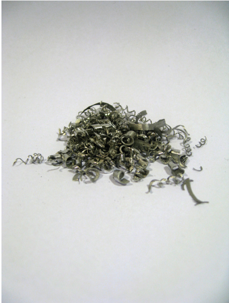
Steel swarf from milling. Stahlspäne entstanden beim Fräsen.
